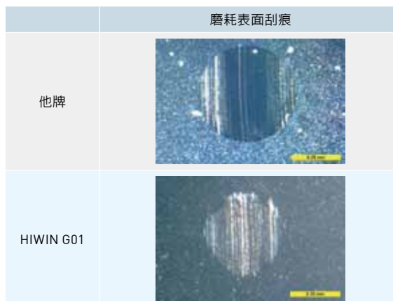
在不同潤滑脂潤滑情況下之鋼球磨耗金相圖
